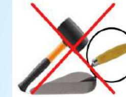
É proibido utilizar martelo de borracha, cabo de colher ou qualquer outro tipo de ferramenta para bater nas molduras.
